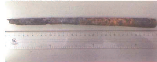
従来型熱電対の腐食例
